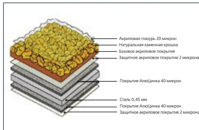
Благодаря покрытию из натуральной каменной крошки, черепица Gerard (Джерард) обладает дополнительной защитой от механических повреждений и уникальными для металлочерепицы шумозащитными свойствами. Вес одного листа составляет всего 3,5кг (~6,22 кг/м<sup>2</sup>), что почти в шесть раз легче керамической черепицы.
